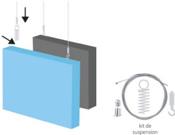
La méthode d'installation de notre baffle est simple et rapide. En effet, aucun technicien spécialisé n'est nécessaire pour réaliser l'installation. Chaque baffle est livré avec un nombre crochets de suspension correspondant à la taille du baffle. Les crochets en spirale doivent être montés à environ 150mm à 200mm du bord du panneau.
